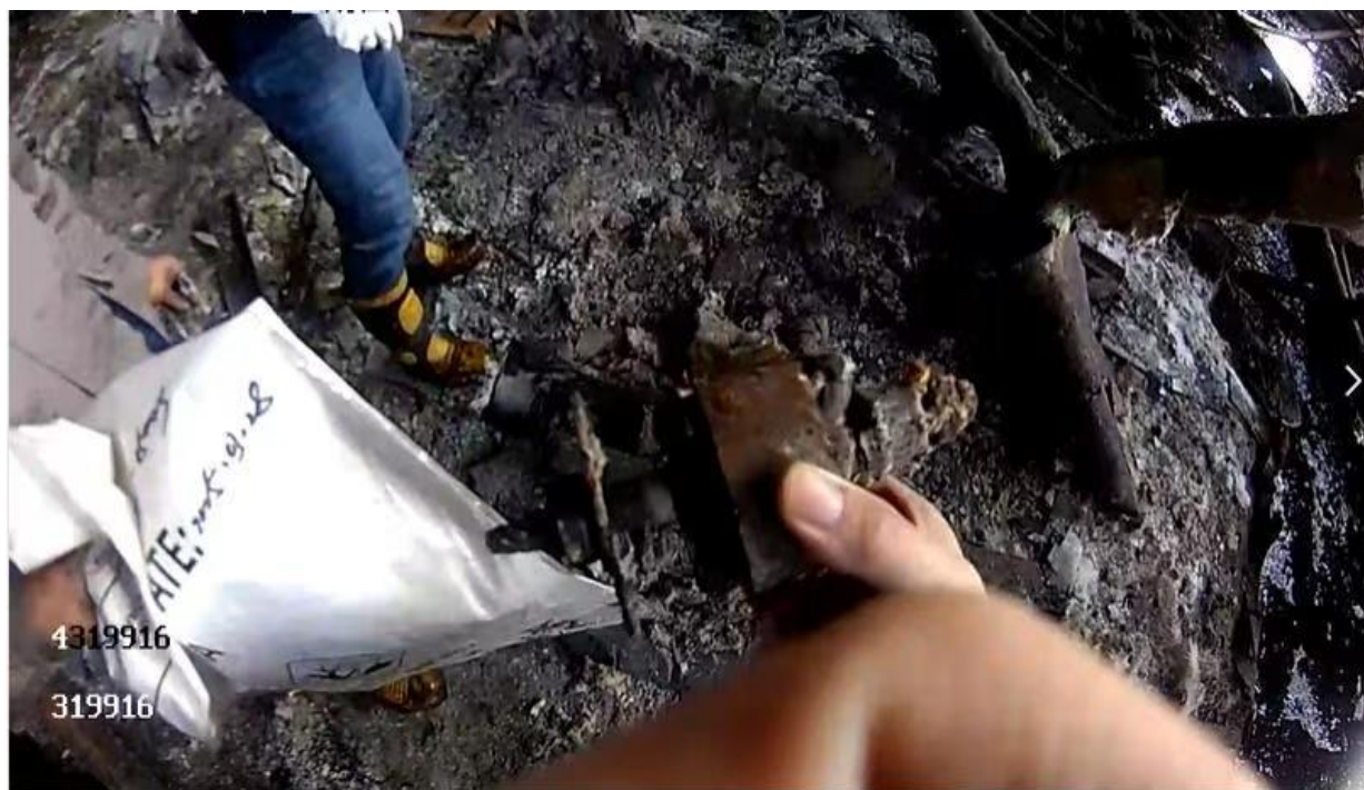
图 7 现场发现已烧毁充电式无刷往复锯
