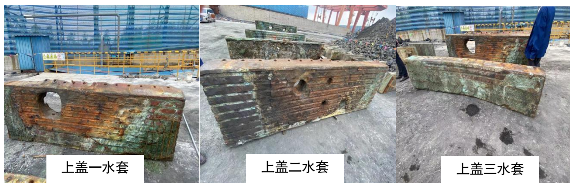
图 6 铜井上盖水套现状勘验图
