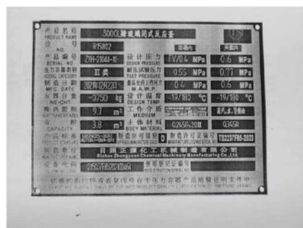
[5] 搪玻璃：将含硅量高的瓷釉涂于金属表面，通过 950℃搪烧，使瓷釉密着于金属铁胎表面制成，具有类似玻璃的化学稳定性和金属强度的双重优点。
