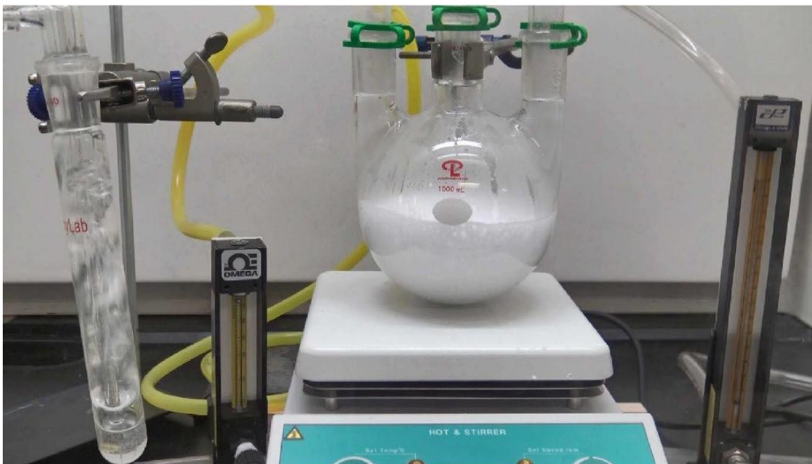
图C8。TD-KOH测试前几秒钟接头由于大量气体产生。（信用：起重机）
