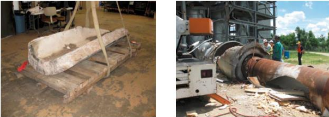
图 9 容器碎片进行冶金测试和除去隔绝层
