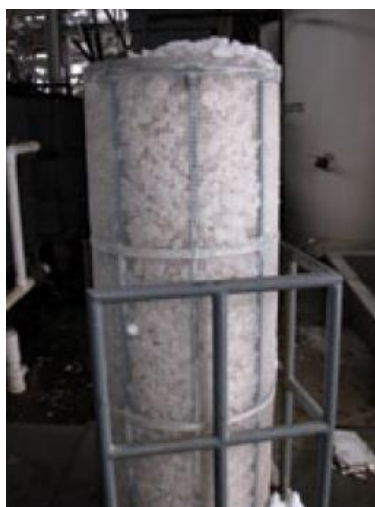
图 3 经加工的石英矿或拉斯卡吊装到容器底部的篮子中
