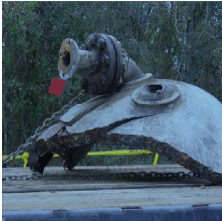
图 4：76.2mm 厚的反应器封头的碎片
