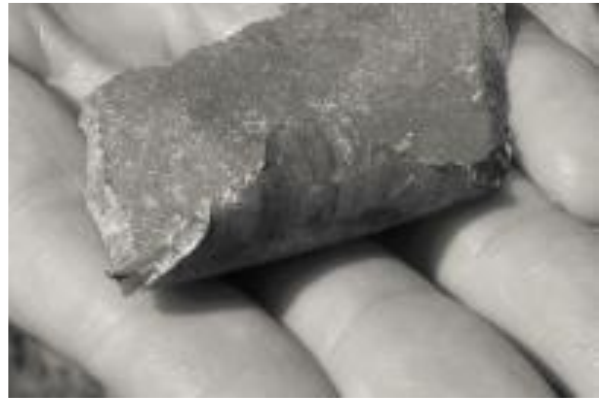
图 9：事故现场破裂的不锈钢管道的以及真空夹套不锈钢碎片
