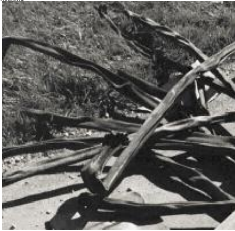
图 9：事故现场破裂的不锈钢管道的以及真空夹套不锈钢碎片
