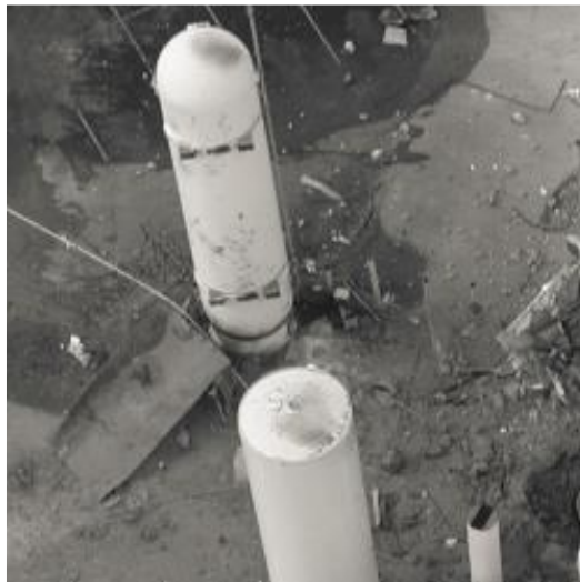
图 7：52,000 磅、高 42 英尺的一氧化碳容器被防护钢板推出 10 英尺远
