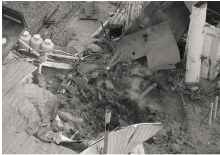
图 6：一氧化氮处理单元爆炸造成的直径达 20 英尺、8 英尺深的弹坑和建筑损坏
