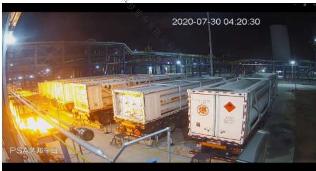
图 6 3 号车操作箱上单瓶控制阀处泄漏的氢气起火燃烧
