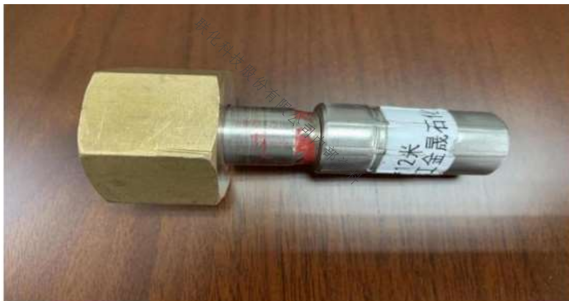
图9 事故软管管接头
