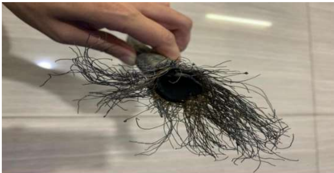
图8 事故软管断裂口
