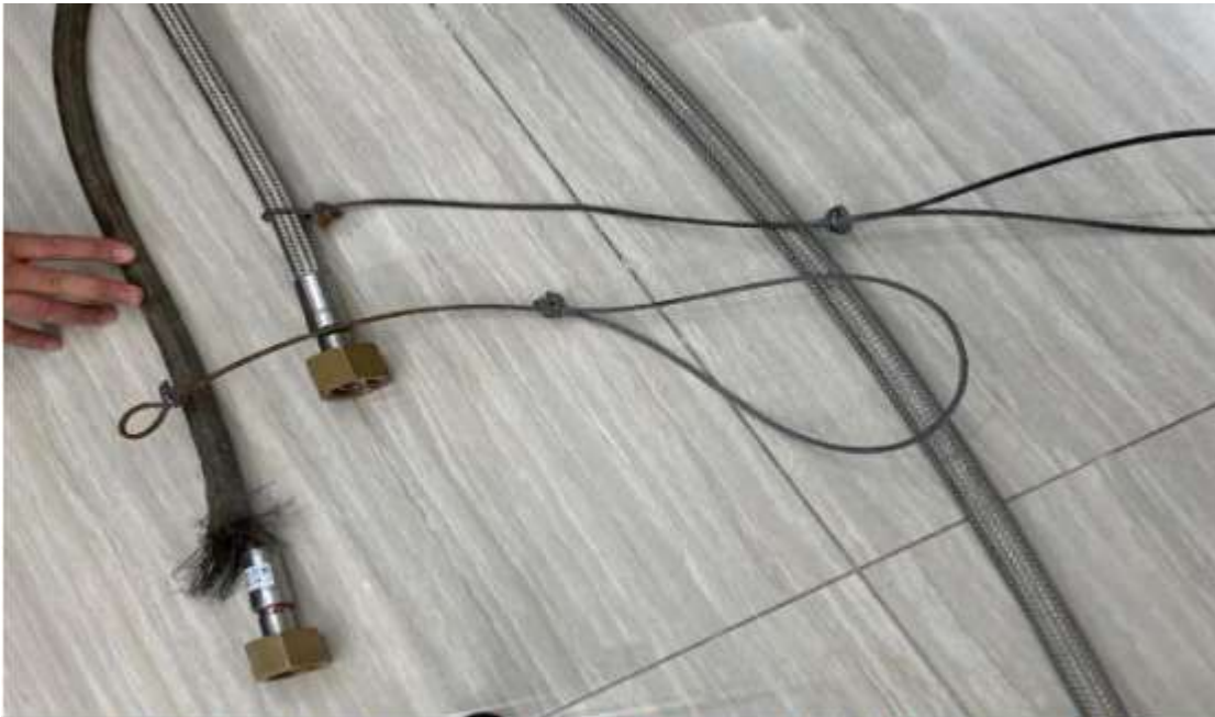
图11 事故软管防脱落防甩动绳（断裂端防脱落防甩动绳已脱落）
